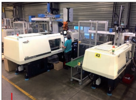
Ces deux presses tout-électriques Woojin sont équipées de robots Sepro.
