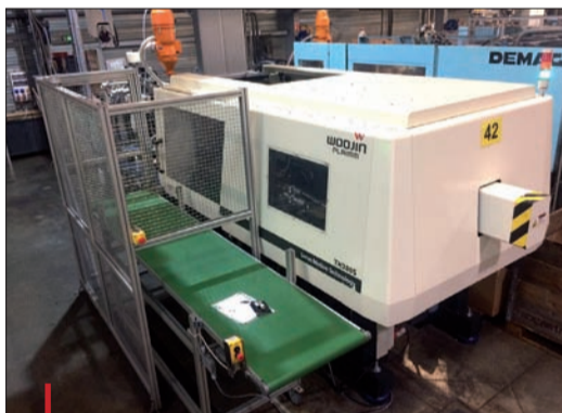
Presse hydraulique Woojin 280 t équipée d'une servo-pompe économisant l'énergie.
