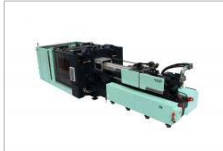
Neue, vollhydraulische Zweiplatten-Maschinenbaureihe DL-A5 - (Alle Bilder: Woojin Plaimm, Leobersdorf (A)).
