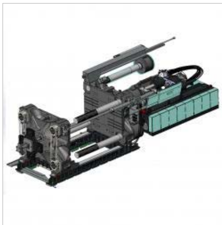
Automatische Holmzieheinrichtung der DL-A5-Baureihe.
