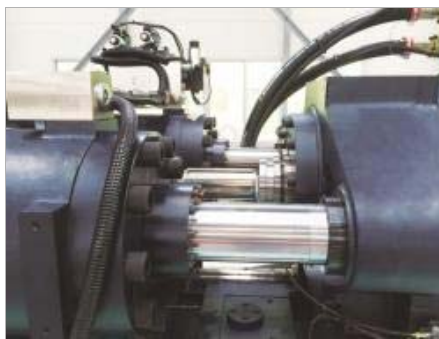
Kraftvoller Doppelzylinder des Einspritzaggregats
