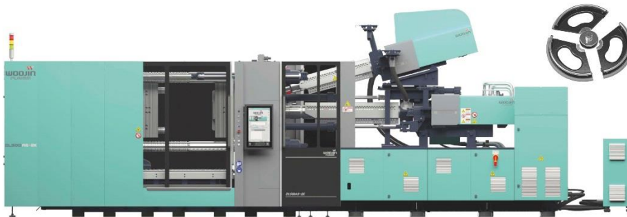
Abbildung 2: Das Segment eines Rollstuhl-Rades wird in 2-K-Technologie und mit Hilfe von Wasserinjektions-Technik auf einer DL500A5-2K im Umsetzverfahren hergestellt.
